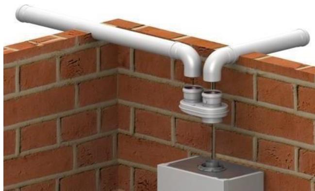
Рисунок 5. Схема присоединения адаптера перехода \varnothing 60/\varnothing 100 мм на \varnothing 80 мм
